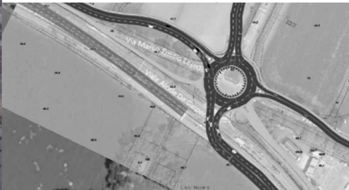
La realizzazione di una nuova rotatoria permetterà la realizzazione del sottopasso De Gasperi senza necessità di impattare il traffico.
