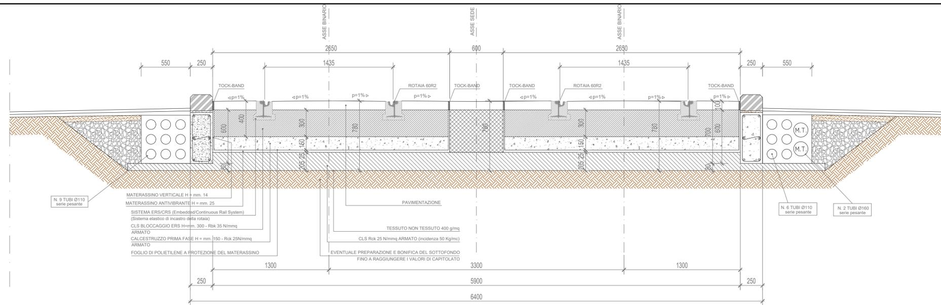
SEZIONE TRASVERSALE TIPO L2 - RIVESTIMENTO IN LASTRE DI PIETRA, CUBETTI DI PORFIDO O CONGLOMERATO BITUMINOSO CON MATERASSINO
