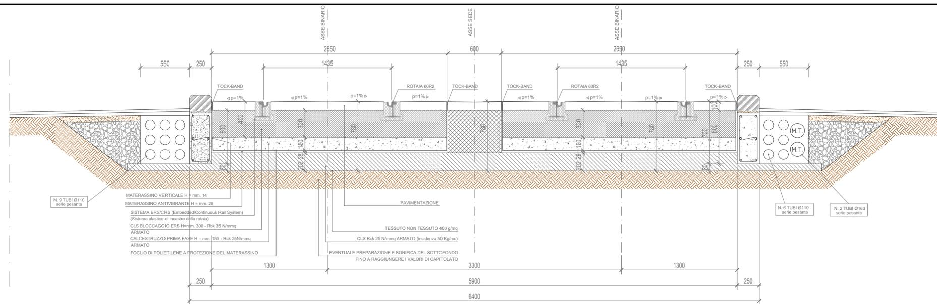
SEZIONE TRASVERSALE TIPO L3 - RIVESTIMENTO IN LASTRE DI PIETRA, CUBETTI DI PORFIDO O CONGLOMERATO BITUMINOSO CON MATERASSINO CON MAX SMORZAMENTO
