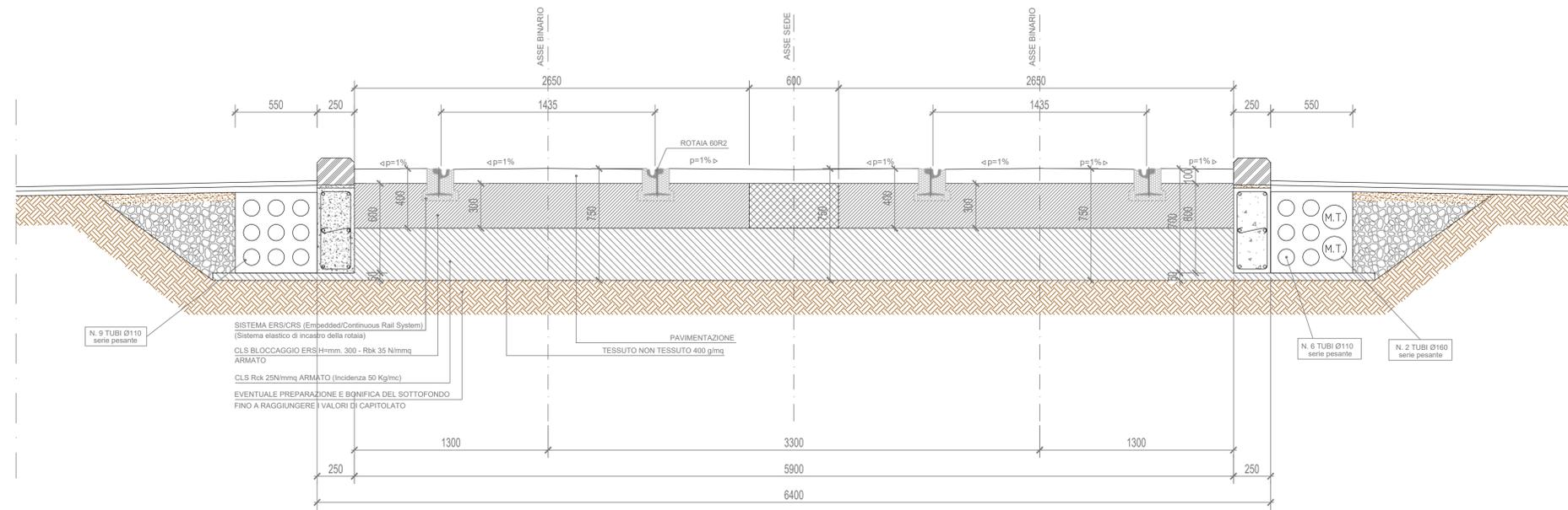
SEZIONE TRASVERSALE TIPO L0 - RIVESTIMENTO IN LASTRE DI PIETRA, CUBETTI DI PORFIDO O CONGLOMERATO BITUMINOSO SENZA MATERASSINO
